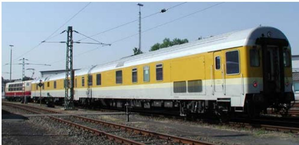
*Abbildung 2.3: Gleismesswagen OMWE (Deutsche Bahn AG)*
