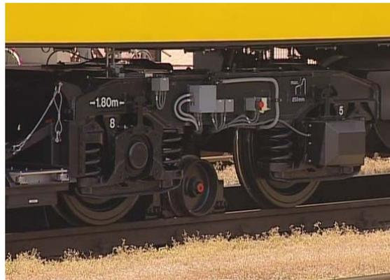
Abbildung 2.4: Messrad zur Bestimmung der Bogenlänge
